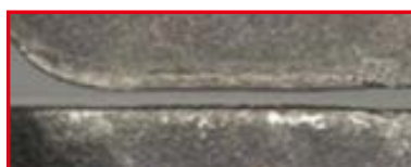
Filo de corte menos susceptible al desgaste al mecanizar acero inoxidable
