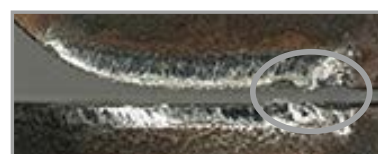
Filo de corte dañado
